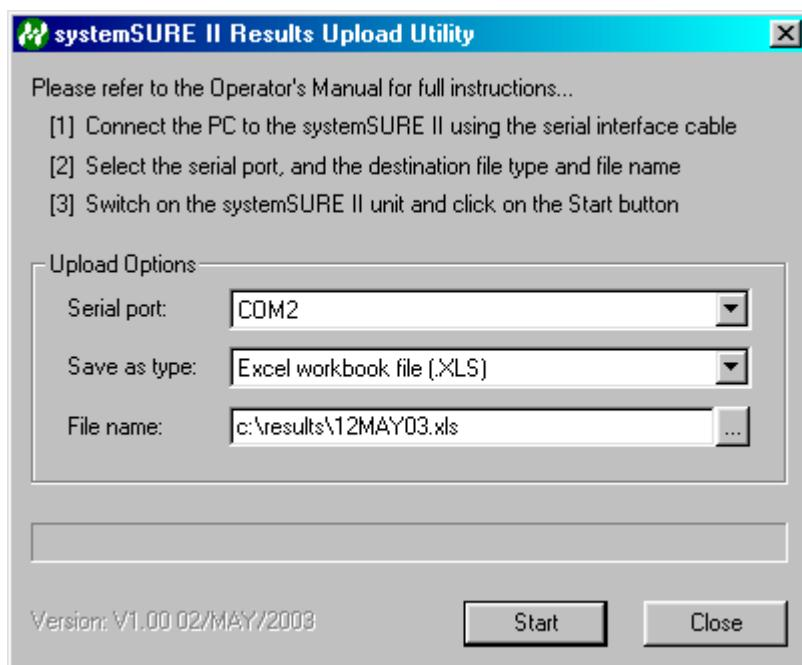
Теперь необходимо соединить прибор с помощью черного соединительного кабеля с одним RS232 СОМ портов:
