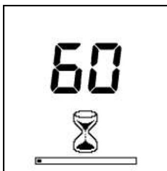
**ПРИМЕЧАНИЕ:** Во время самокалибровки, гнездо для пробирки Ultrasnap должно быть пустым, а крышка прибора закрыта. В случае, если на дисплее высвечивается символ с мигающей стрелкой, необходимо открыть крышку и вынуть пробирку Ultrasnap из гнезда.
